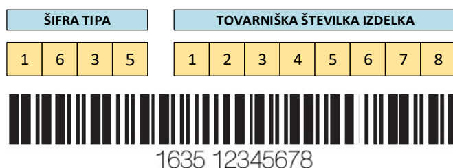
Slika 6: Zgradba črtne kode GS1-128
